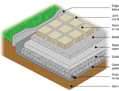
Edge restraint - concrete depth below bedding rock
